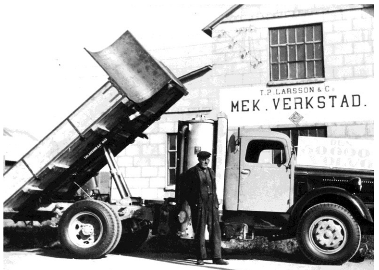
Täpp Per, den 10000 Volvo-lastbilen med Nås-tippen och gengasaggregat.
